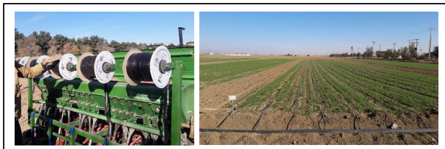
شکل ۱۲- دستگاه کمبینات بذرکار و بهن کننده نوار آبیاری قطره‌ای (تیپ) (به صورت همزمان)
